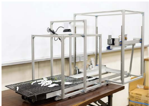
自動養蚕工場チームが製作した装置。上部のカメラで取得した画像を解析し、葉の補給と掃除を行う優れものだ。
