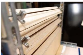
柵の模型は、パソコンで数値を入力すると羽が動く仕組み。本物の雪を使った実験映像(左上)では、羽の角度と雪の動きの関係がよくわかった。
