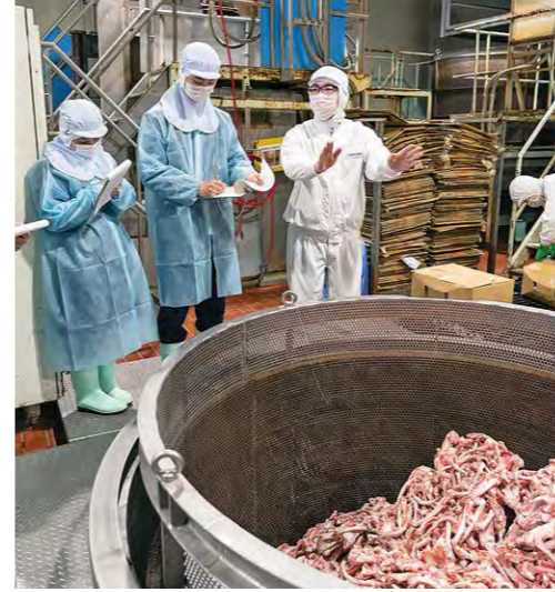
スープの抽出に使う釜は、骨と水が2トンずつ入るとも大きなもの。この釜が合計16個もあるというから驚きだ。
