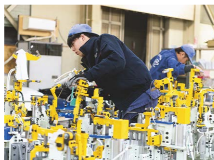
組み上がった後、動作を確認しながら細部の調整が行われる。
