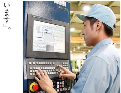
プログラムをセットし、何台もの機械を併行して稼働させる。
