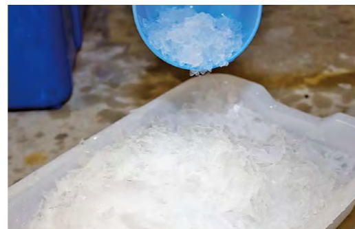
製造装置でつくられる窒素氷は、2mmほどの厚さのフレーク状。
